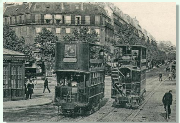
Deux tramways électriques à accumulateurs, système Heilmann, construits à 35 exemplaires pour la Compagnie des tramways de Paris et de la Seine en 1897
